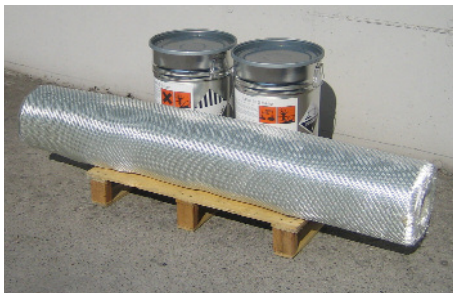
Epoxidharz ist nicht gleich Epoxidharz: Je nach Qualität verbessert sich die Festigkeitsklasse um bis zu 30 %.
