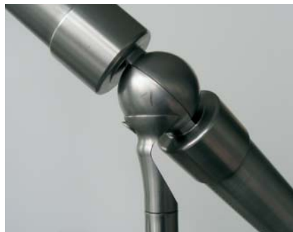
Mit aufeinander geschraubten Halbkugeln lässt sich der Handlauf in beliebigen Winkeln um die Ecke leiten
