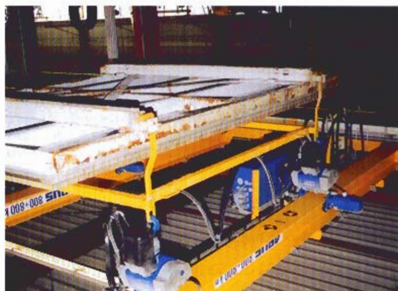
Bild 6: ABUS-Spezialkran für den Rücktransport der Bänkewagen
