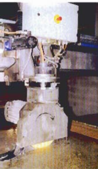
Bild 4: Brückensäge mit drehbarem Sägesupport
