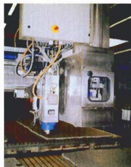
Bild 3: Bohr- und Fräsmaschine mit Etikettendrucker und -aufkleber
